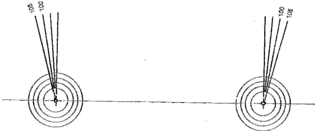
Abb. 19 Schablone für die Winkelmessung nach NORBERG
